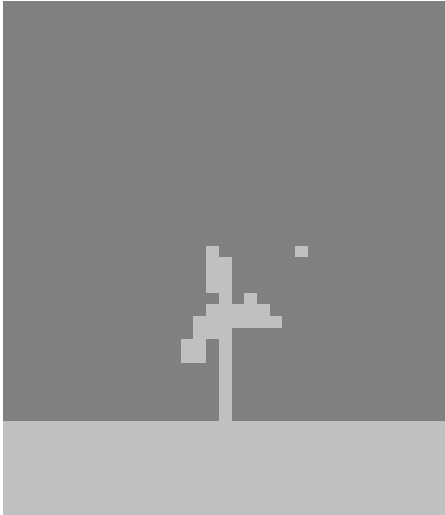
Kuva 5.3-1b. Voimalan etäisyys sensorista 10 km, pikselikoko 1 mrad 2 eli 10 x 10 m 2 . Toinen lentävä kohde erottuu, toinen alkaa sulautua voimalaan.
