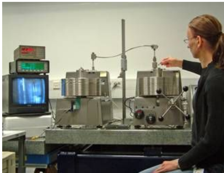
Kuva 5. Painevaakojen ristiinkellutus. Painevaa'at on kytketty samaan paineverkkoon. Tasapainotus suoritetaan pienten säätöpunnusten avulla. Herkät painevaa'at reagoivat jo 10 milligramman muutokseen.
