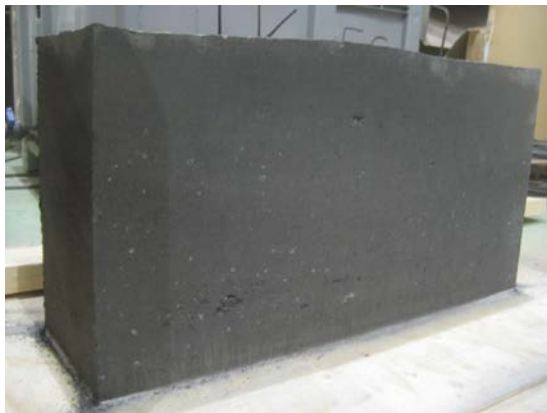
Kuvaaja 2. Jätetuhkista VTT:llä valmistettu muurirakenne.
